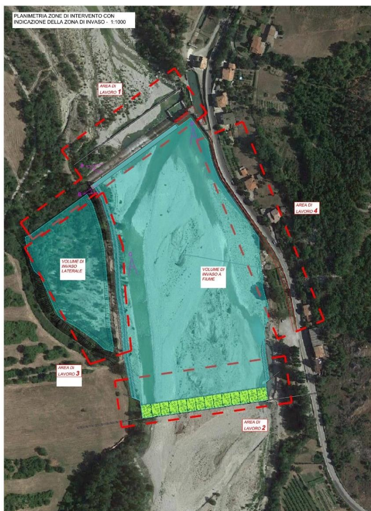
Figura 41: individuazione dell'area invasata a tergo dello sbarramento gonfiabile e lateralmente.
