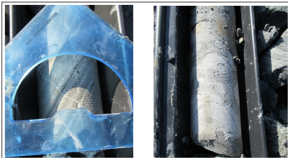
figura 40: lamine piano parallele e convolute in uno strato arenaceo di S1
