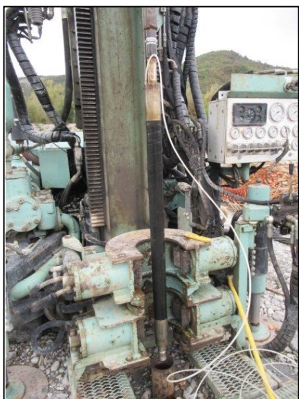
figura 50: packer singolo
