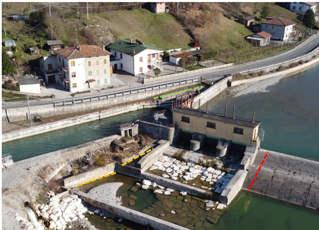
Figura 16: identificazione opere provvisionali
