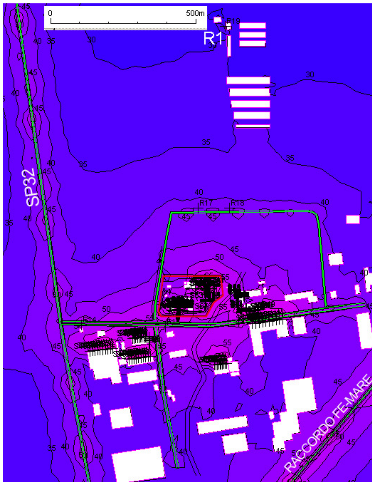
Fig.7 Mappatura isofonica (h.3 m) a grande scala della situazione post operam notturna
