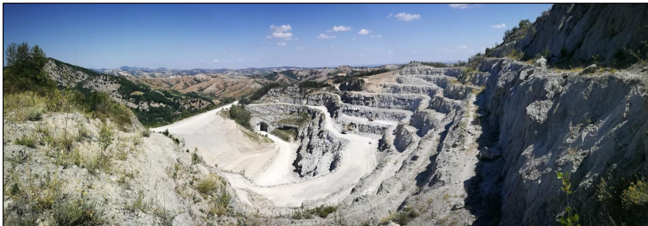
Foto 4: Vista generale da gradone 320. Sono visibili i gradoni sottostanti da coltivare e quelli soprastanti già in fase di ripristino che continuerà negli anni. Il mezzo d'opera transita sul gradone 265 che verrà lasciato di ampiezza circa 16 m per consentire anche in futuro
