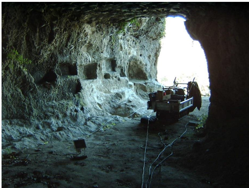
Foto 5: Prospezioni geoelettriche (tomografia) ingresso grotta Re Tiberio
