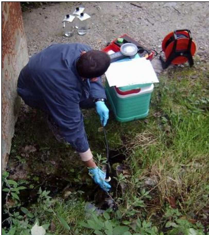
Foto 8 : Prelievi di acque da un piezometro
