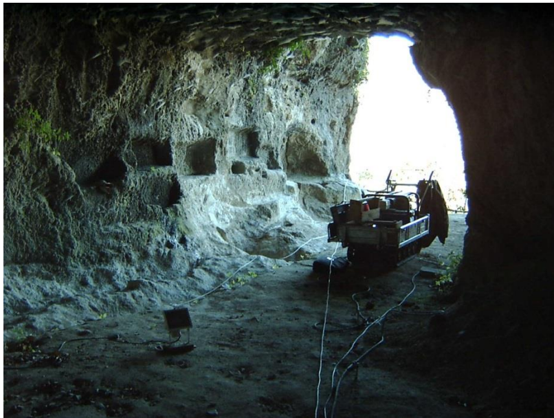
Foto 5: Prospezioni geoelettriche (tomografia) ingresso grotta Re Tiberio
