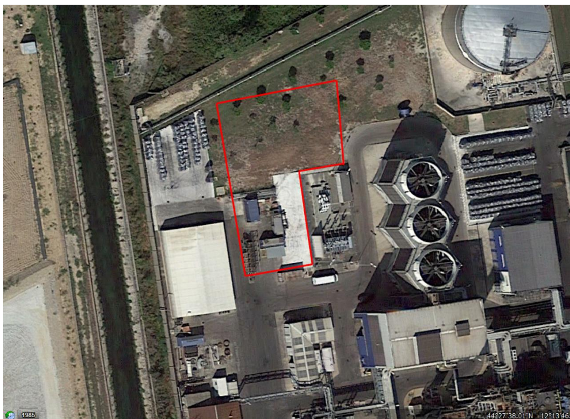
Figura 3 – Ubicazione del nuovo trasformatore e del relativo stallo (in rosso)
