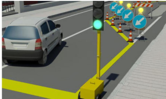
Esempi grafici di regolamentazione del traffico stradale in presenza di cantiere
