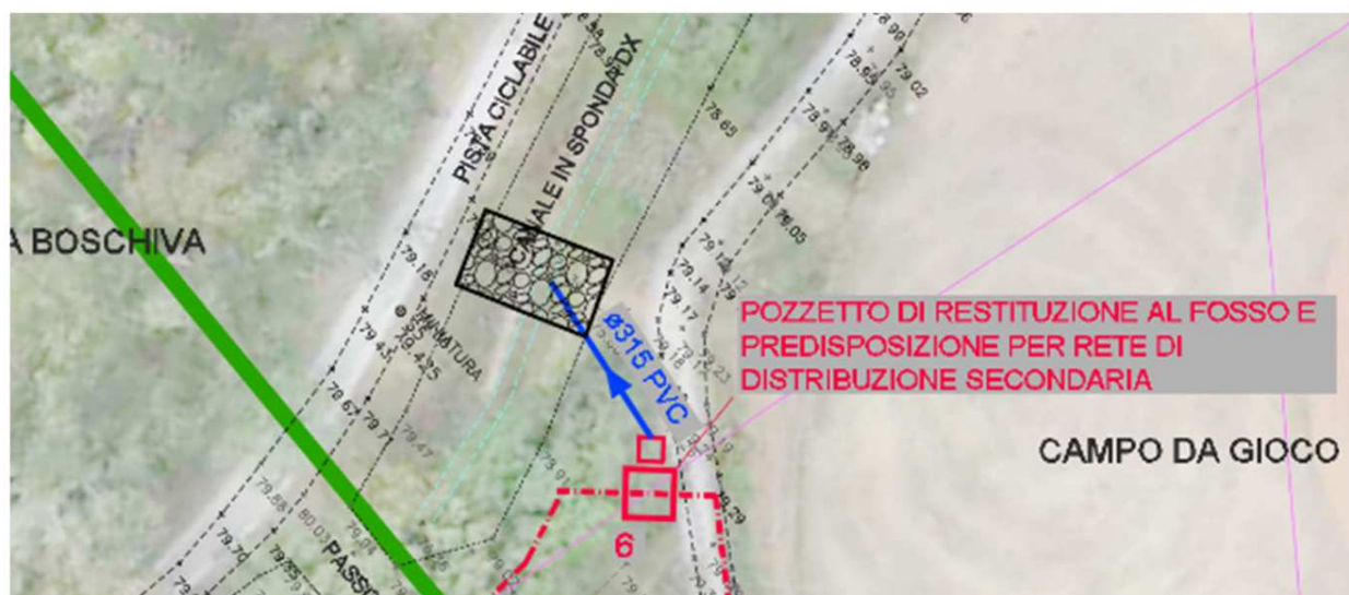
Figura 17: Esempio di nodo di restituzione al canale Dx Marecchia e predisposizione per collegamento della futura rete secondaria
