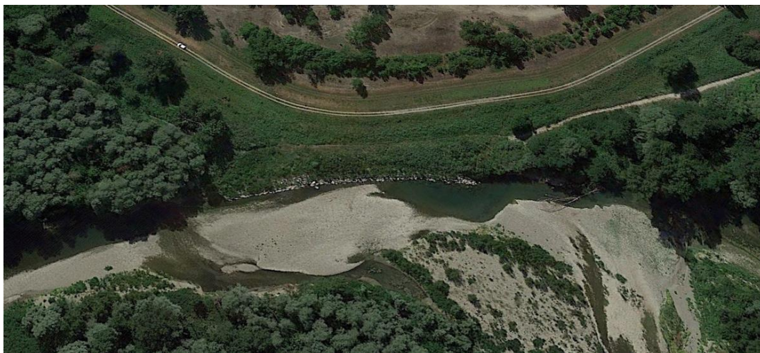
Foto 2 – Vista aerea (da Google Earth ) dell’erosione della sponda destra del fiume Secchia in un tratto in cui l’argine della cassa d’espansione è praticamente in frodo
