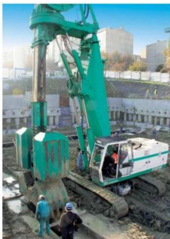
Figura 8 – Perforatrice cingolata tipo Casagrande B180HD
