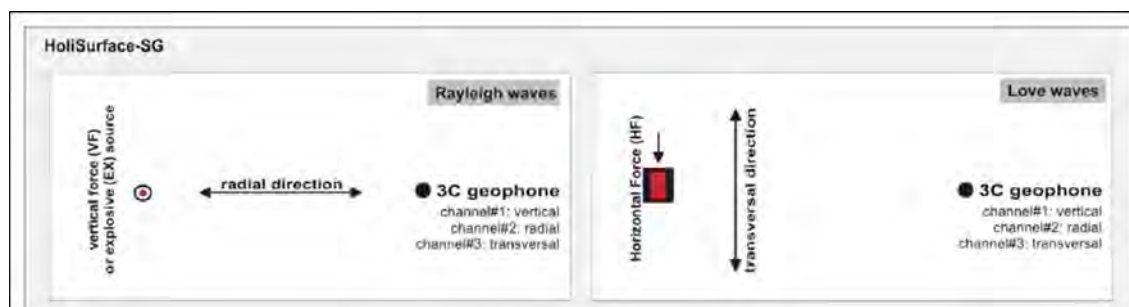
Figura 5.3: schema acquisizione dati.
