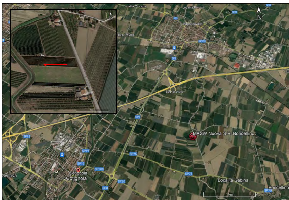
Figura 1.1: orto-foto satellitare con identificazione area di indagine e traccia dello stendimento sismico (Immagine da Google Earth).
