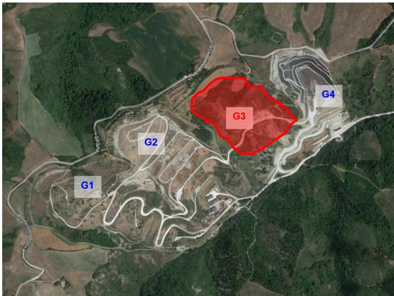
Figura 6: Immagine aerea del sito di Ginestreto con indicazione delle discariche esistenti, G1 e G2 in fase di post- gestione e G4 in fase di coltivazione e della discarica G3 in progetto.
