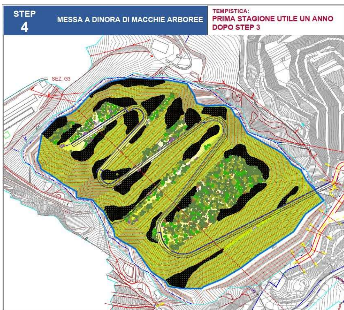
Figura 23 - Stralcio della “Planimetria stato di progetto delle opere a verde” (elab. 2.3) con indicazione dell’area di intervento per la messa a dimora di macchie arboree.
