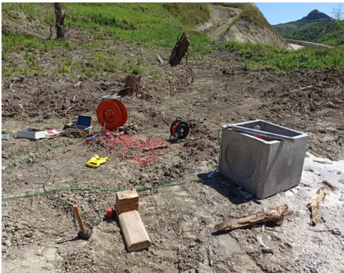
postazione inclinometro ed allestimento rilevamento microsismico Down-Hole
