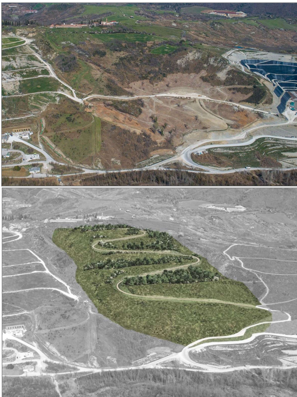
Figura 6 – Rendering dello stato dei luoghi a seguito degli interventi di ripristino ambientale una volta completata la coltivazione della discarica (in basso). In alto lo stato attuale della vallecola denominata G3, con G2 in fase di post-gestione (a sx) e G4 in fase di gestione (a dx).
