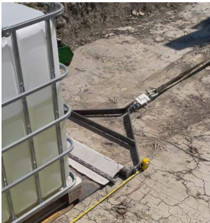
Fig. 3-4 Sistema di tiro con cella di carico fino a 30kN.
