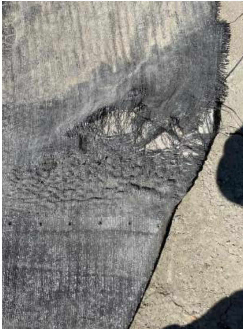
Fig. 3-5 Geotessuto sfibrato al carico limite di 50kN.
