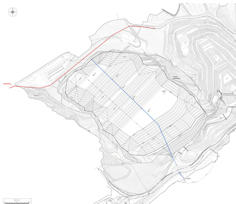
Figura 1 - Planimetria di progetto dell'abbancamento dei rifiuti non pericolosi
