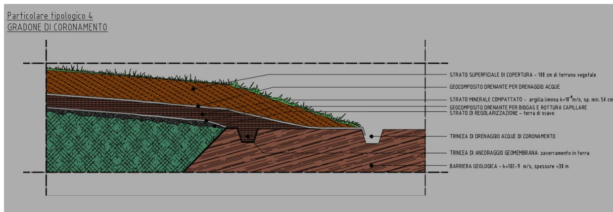
Figura 16 . Particolare del sistema di copertura finale.
