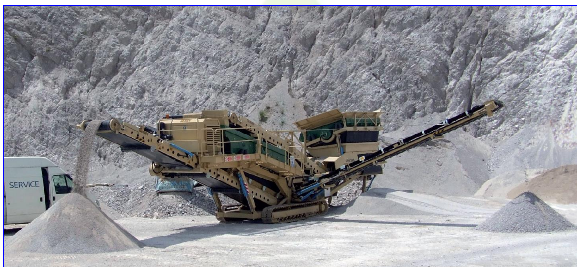
Figura 27 – Vaglio vibrante mobile
