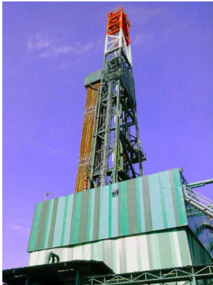
Fig. 16. Impianto perforazione tipo DRILLMEC MAS8000 (fonte: sito PERGEMINE)
