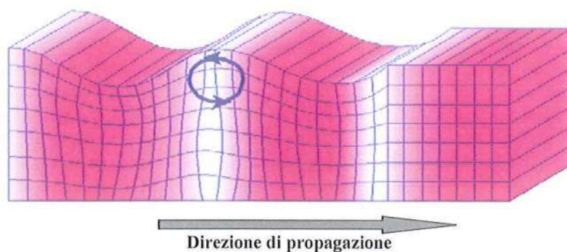
Fig. 1 - Rappresentazione grafica della propagazione delle onde superficiali di Rayleigh caratterizzata dall'oscillazione polarizzata in un piano verticale e con movimento delle particelle retrogrado rispetto al senso di propagazione dell'onda.
