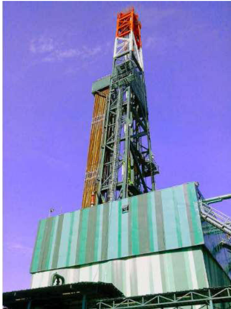
Figura 11. Impianto perforazione tipo DRILLMEC MAS8000 (fonte: sito PERGEMINE)
