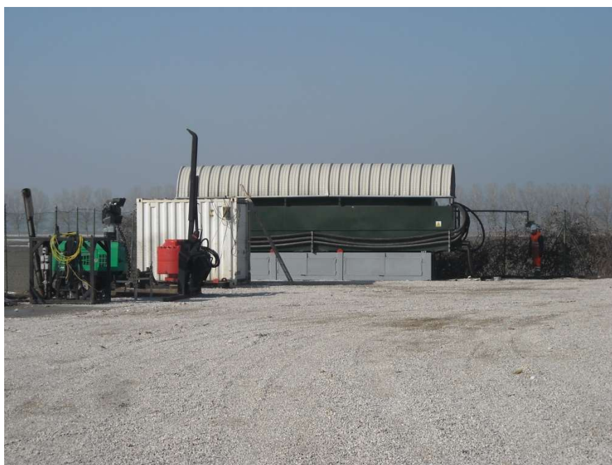
Foto raffigurante il serbatoio del gasolio sul piedistallo di supporto e container degli oli, in una postazione analoga
