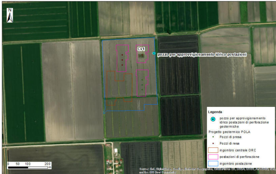
Ripresa aerea – area individuata per la perforazione del pozzo per approvvigionamento idrico delle postazioni di perforazione del progetto geotermico POLA (azzurro)
