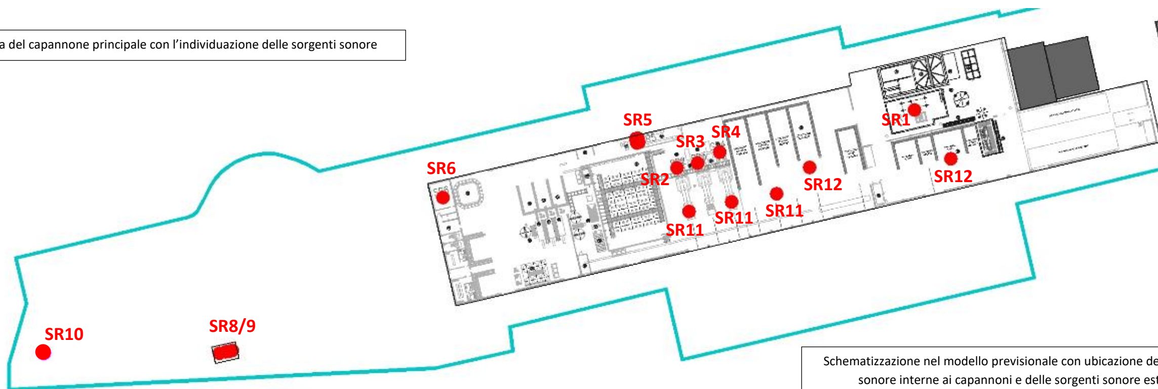
Figura 5 – Planimetria del capannone principale dell'impianto e schematizzazione dell'impianto nel modello di simulazione con l'ubicazione delle sorgenti sonore
