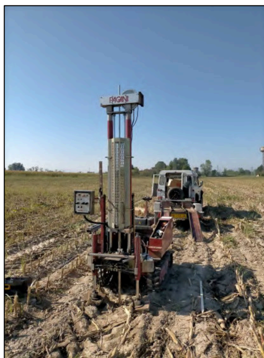
Fig. 5 – Penetrometro Pagani TG63 su carro cingolato con campionatore ambientale
