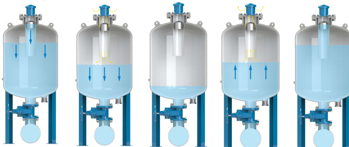
Figura 26 – Schema esempio funzionamento serbatoio anti-colpo d'ariete con sfiato in testa (fonte cataloghi tecnici fornitore tipo CSA s.r.l.), con iniziale svuotamento acqua serbatoio con immissione aria e successivo riempimento nella seconda fase del moto vario con rientro acqua e uscita aria, fino alla stabilizzazione delle pressioni al termine del transitorio.
