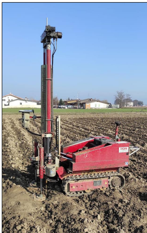
Fig. 11 - Penetrometro dinamico superpesante DPHSH "Pagani"
