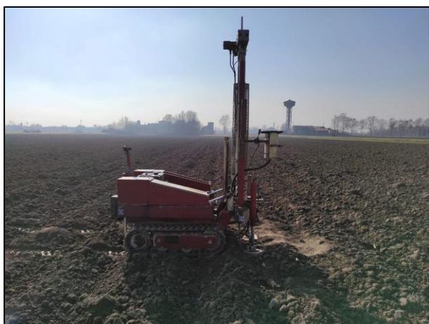
Fig. 7 – A sinistra prova penetrometrica dinamica P1, a destra P2
