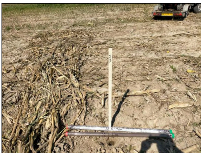
Fig. 4 – Carote di terreno in fustelle metriche
