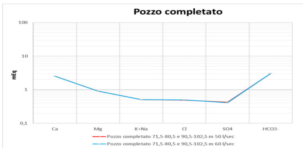
Figura 20 – Diagramma di Schoeller delle acque prelevate durante le prove di portata eseguite sul pozzo esplorativo CLP04 completato e spurgato (filtri tra 71,5-80,5 e 90,5-102,5 m da p.c.)
