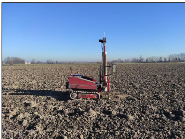
Fig. 8 – A sinistra prova penetrometrica dinamica P3, a destra stendimento sismico per prova MASW M1
