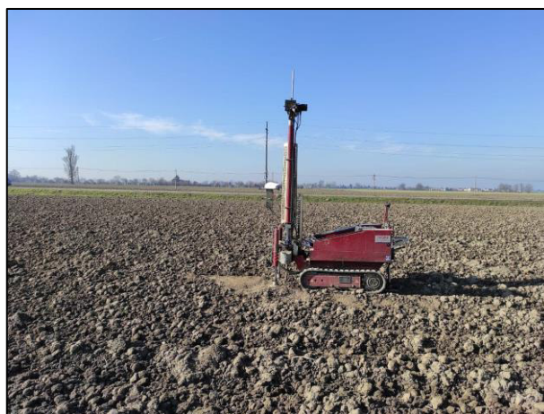
Fig. 7 – A sinistra prova penetrometrica dinamica P1, a destra P2
