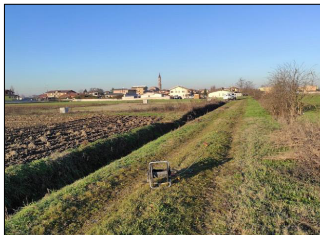
Fig. 8 – A sinistra prova penetrometrica dinamica P3, a destra stendimento sismico per prova MASW M1
