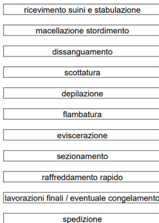
Figura 14. Schema a blocchi semplificato del ciclo produttivo – Assetto attuale.
