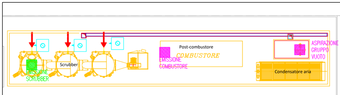
Dettaglio layout area scrubber e post-combustore
