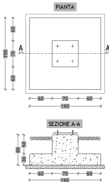
Fig. Vista assonometrica fondazione per trasformatore di corrente
