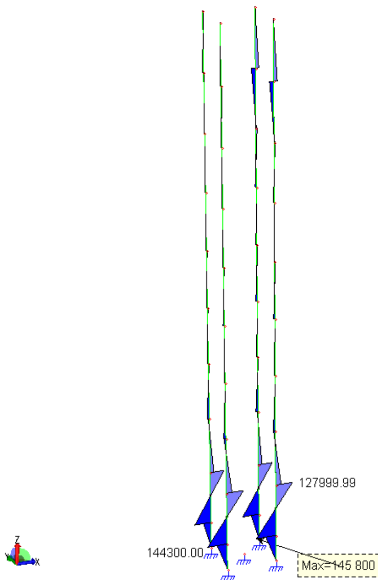
Modello vento diagonale per combinazione 4 statica – Involuppo Momento Flettente M_z Montanti
