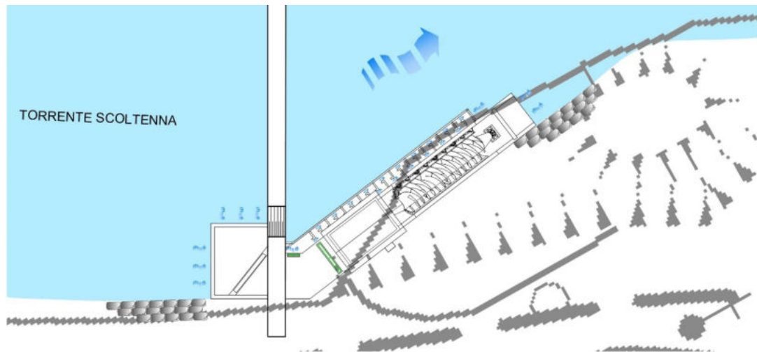
Fig. 2: vista in pianta della centralina in corrispondenza della briglia Mulino Camatti. A monte della briglia è collocato il bacino di captazione con la griglia grossolana di protezione
