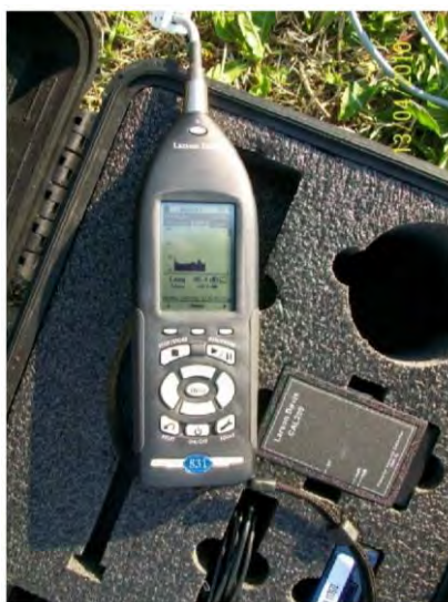
Figura 4 – Fonometro integratore/analizzatore Real Time LARSON DAVIS modello 831
