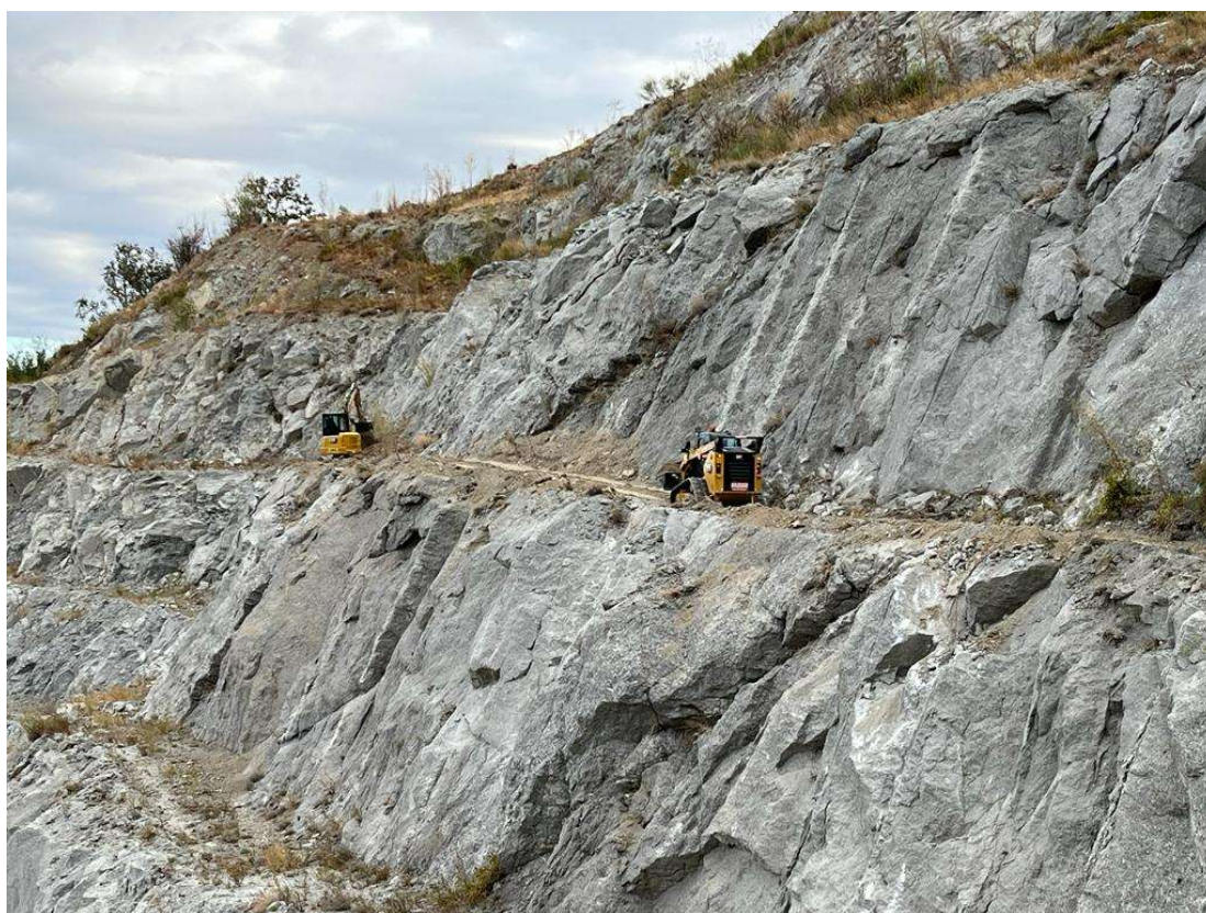
Figura 34: foto delle operazioni di recupero dei gradoni esauriti.
