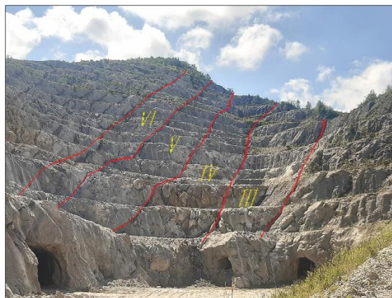
Fig. 1 vista del fronte di scavo orientale della cava Monte Tondo. In rosso sono stati evidenziati i banchi, numerati dal terzo al sesto, di maggiore qualità dal punto di vista minerario. Sono, inoltre, visibili le gallerie della vecchia coltivazione in sotterraneo poste sul piazzale di base a quota 220 m. (Casertano, D., 2023)
