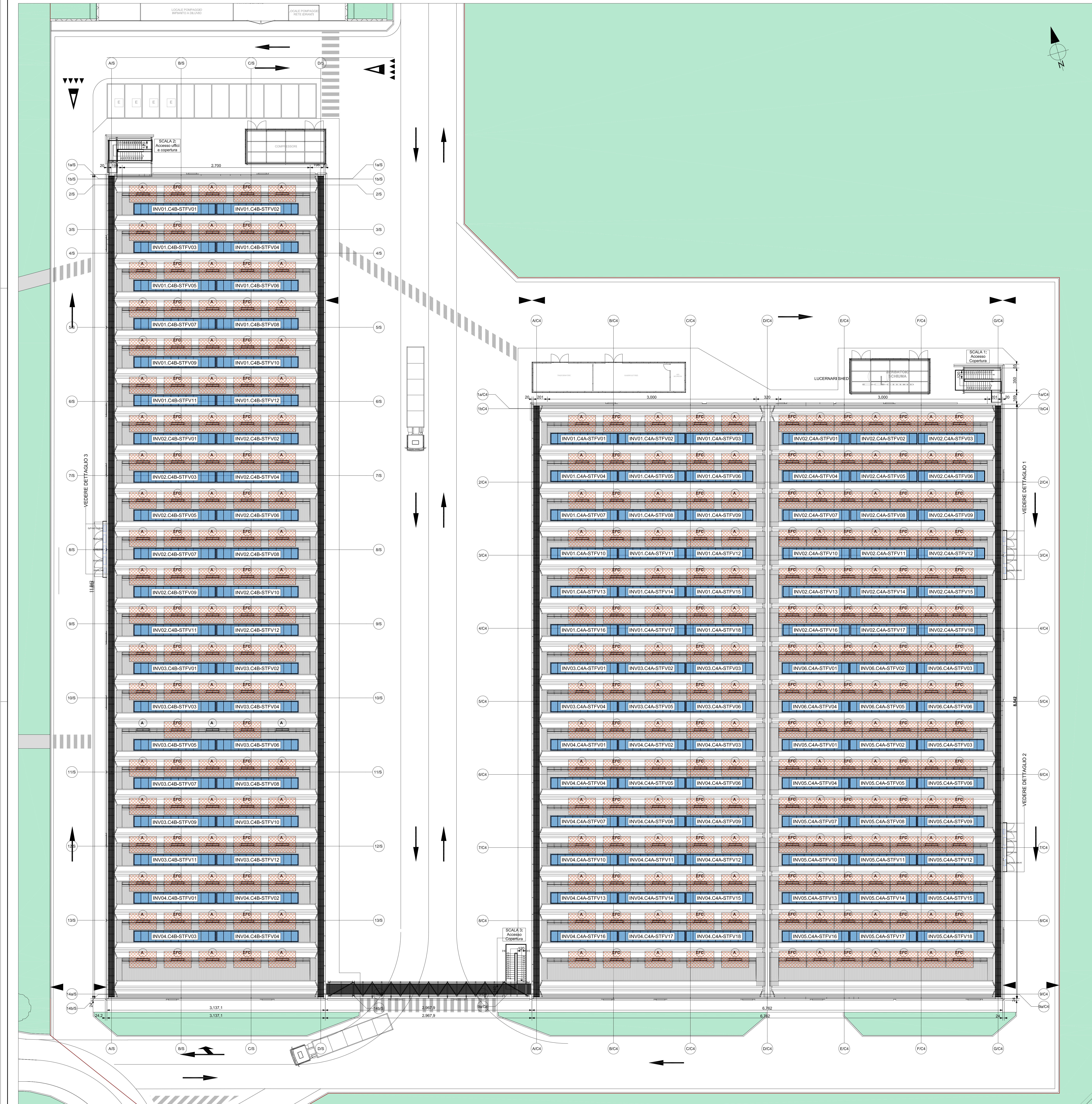
PIANTA COPERTURA FABBRICATI C4A E C4B POSIZIONE PANNELLI FV E LAYOUT STRINGHE SCALA 1:200
