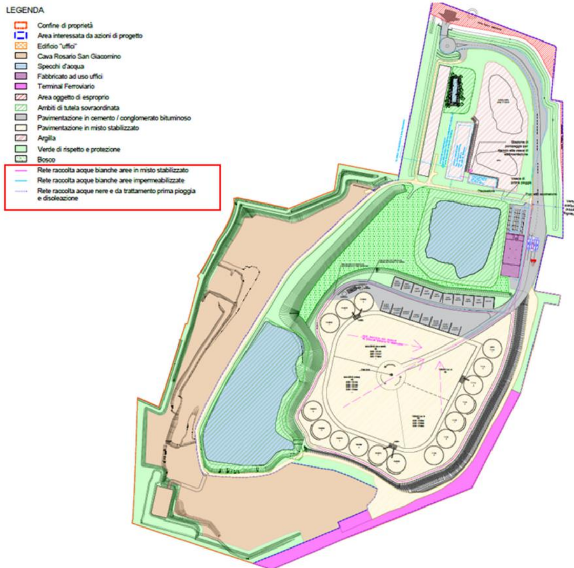
Fig. 4.21 – Linee raccolta e gestione acque meteoriche e manufatti previsti (stralcio Tav. PF T10)
