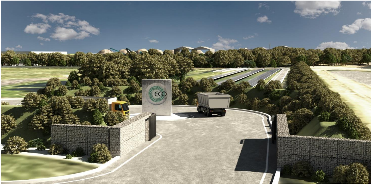
Figura 3 - Rendering area di ingresso in impianto, con gabbionata ed arginature per ridurre la visibilità e le emissioni polverulente e rumorose
