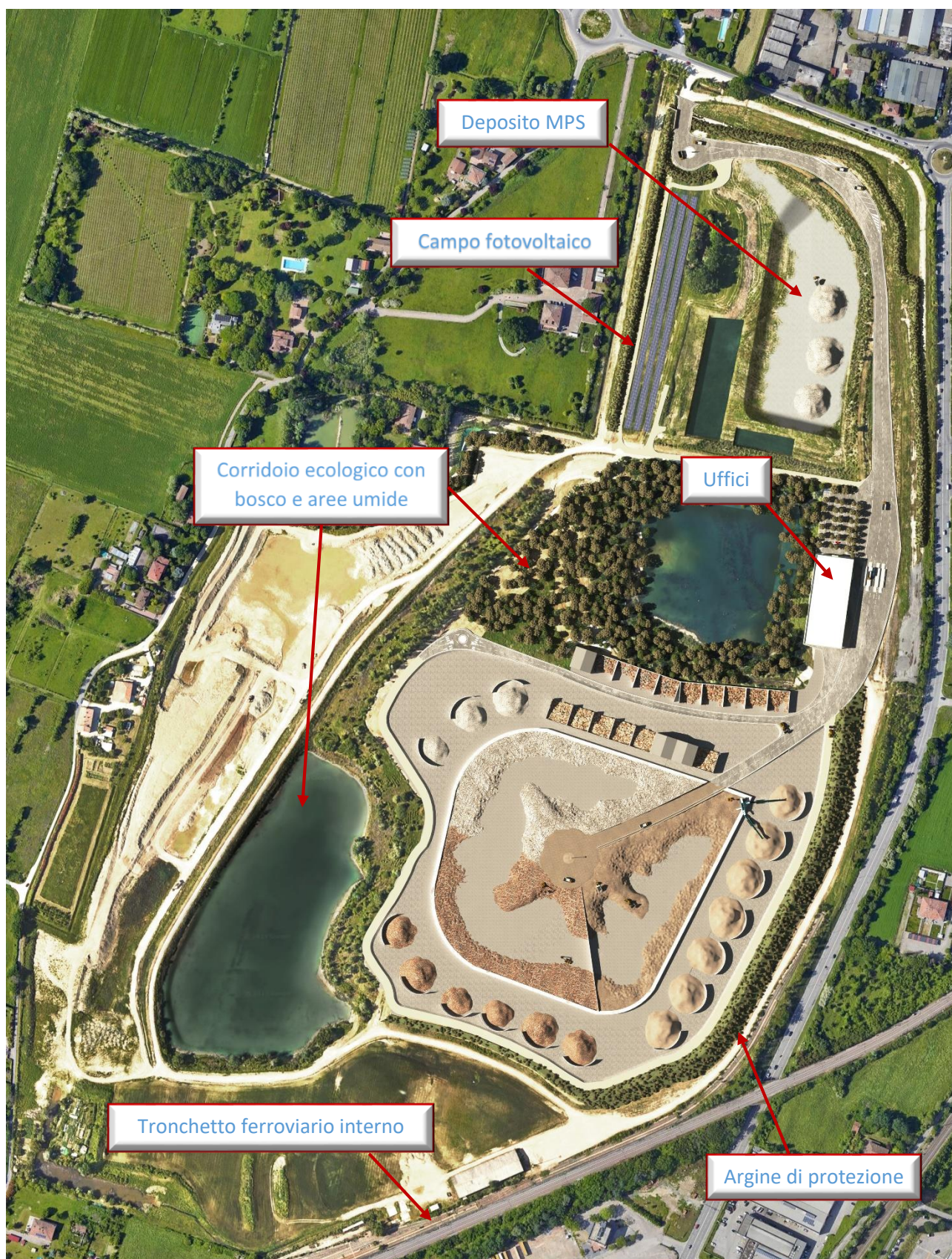
Figura 2 - Rendering di impianto con rappresentazione delle principali aree di progetto
