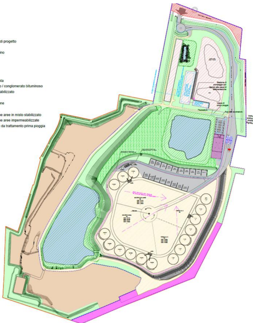
Fig. 4.22 – Linee raccolta e gestione acque meteoriche e manufatti previsti (stralcio Tav. PF-T10)
