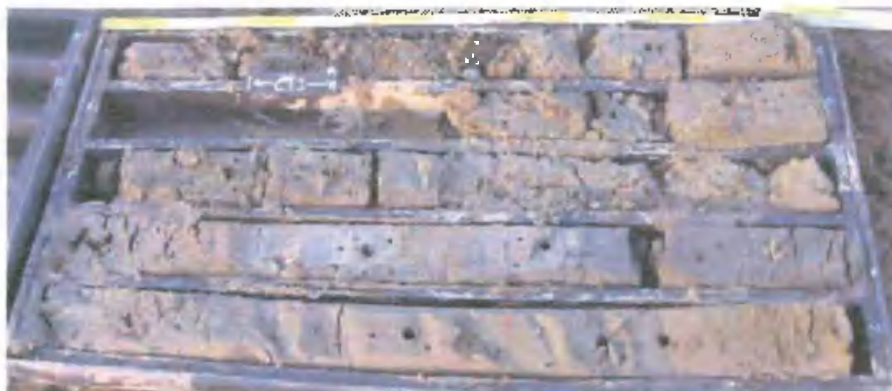
foto 8 sondaggio a carotaggio continuo a rotazione S2-08 da 5,00m a 10,00m da p.c.
