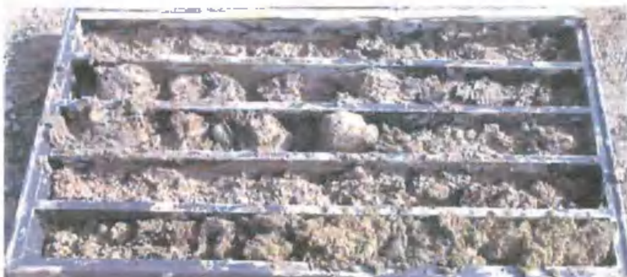
foto 5 sondaggio a carotaggio continuo a rotazione S3-08 da 5,00m a 10,00m da p.c
