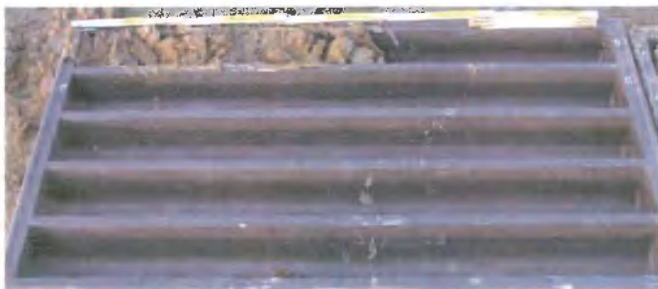
foto 9 sondaggio a carotaggio continuo a rotazione S2-08 da 10,00m a 10,60m da p.c.
