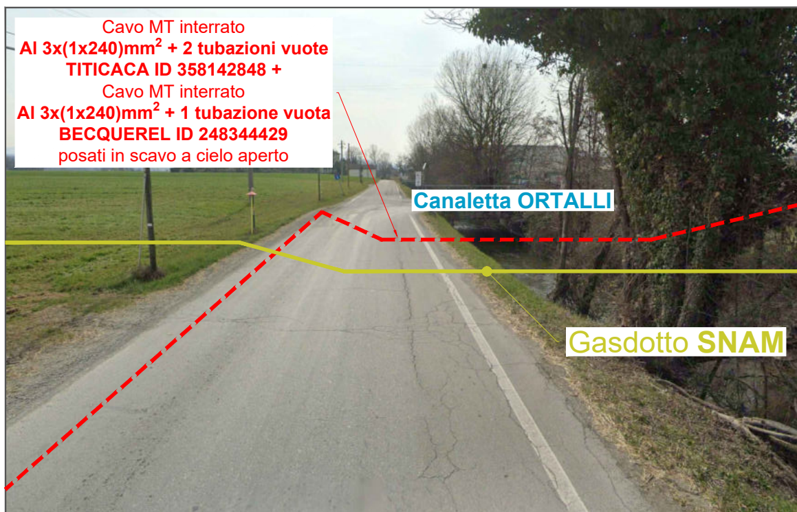
Foto 15: Nuova linea MT in partenza dalla cabina primaria CP COLLECCHIO in percorrenza lungo via Scodoncello ed in attraversamento a Gasdotto SNAM
