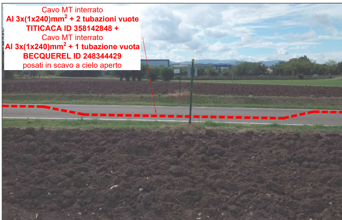
Foto 2: Nuova linea MT in partenza dalla cabina primaria CP COLLECCHIO in transito lungo Strada Varra Superiore, in interferenza con Oleodotto POL.
