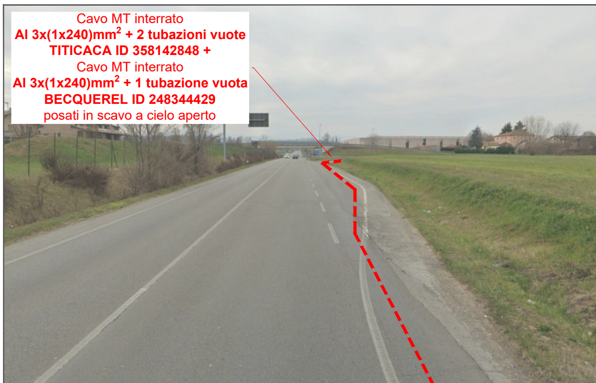
Foto 3: Nuova linea MT in partenza dalla cabina primaria CP COLLECCHIO in attraversamento della Strada Statale 62
