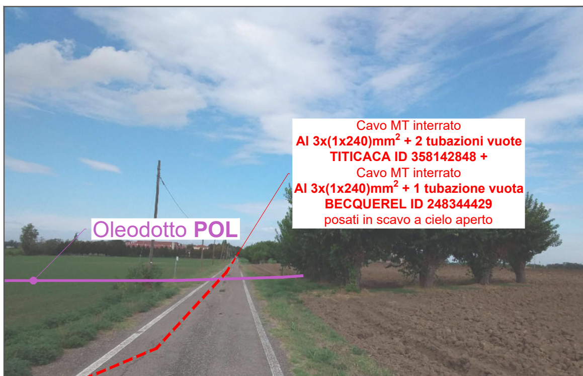
Foto 3: Nuova linea MT in partenza dalla cabina primaria CP COLLECCHIO in transito lungo Strada Varra Superiore, in interferenza in sovrappasso con Oleodotto POL, tratto b''-b''.
