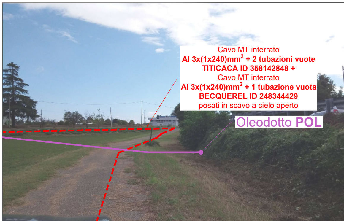
Foto 4: Nuova linea MT in partenza dalla cabina primaria CP COLLECCHIO in transito lungo la pista ciclabile parallela alla SS 62, in interferenza in sottopasso con Oleodotto POL, tratto b'''-b'''.
