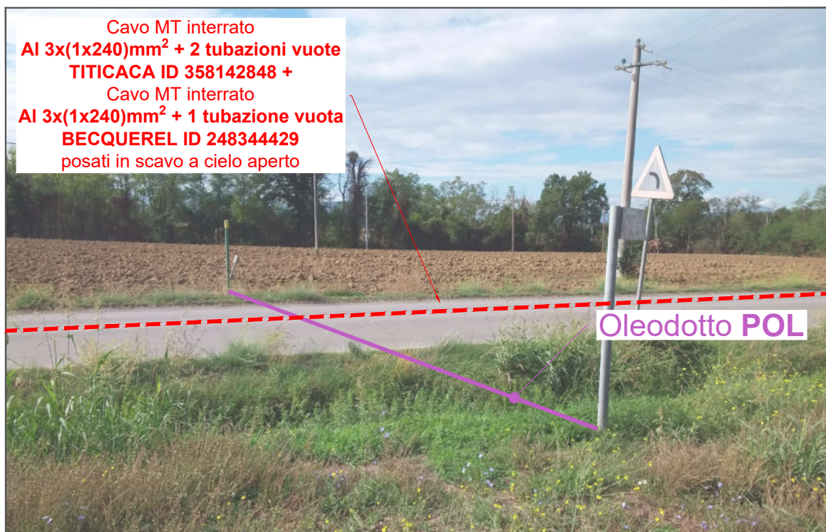
Foto 12: Nuova linea MT in partenza dalla cabina primaria CP COLLECCHIO in percorrenza lungo via Scodoncello e interferenza in sovrappasso con Oleodotto POL, tratto i'-i'.
