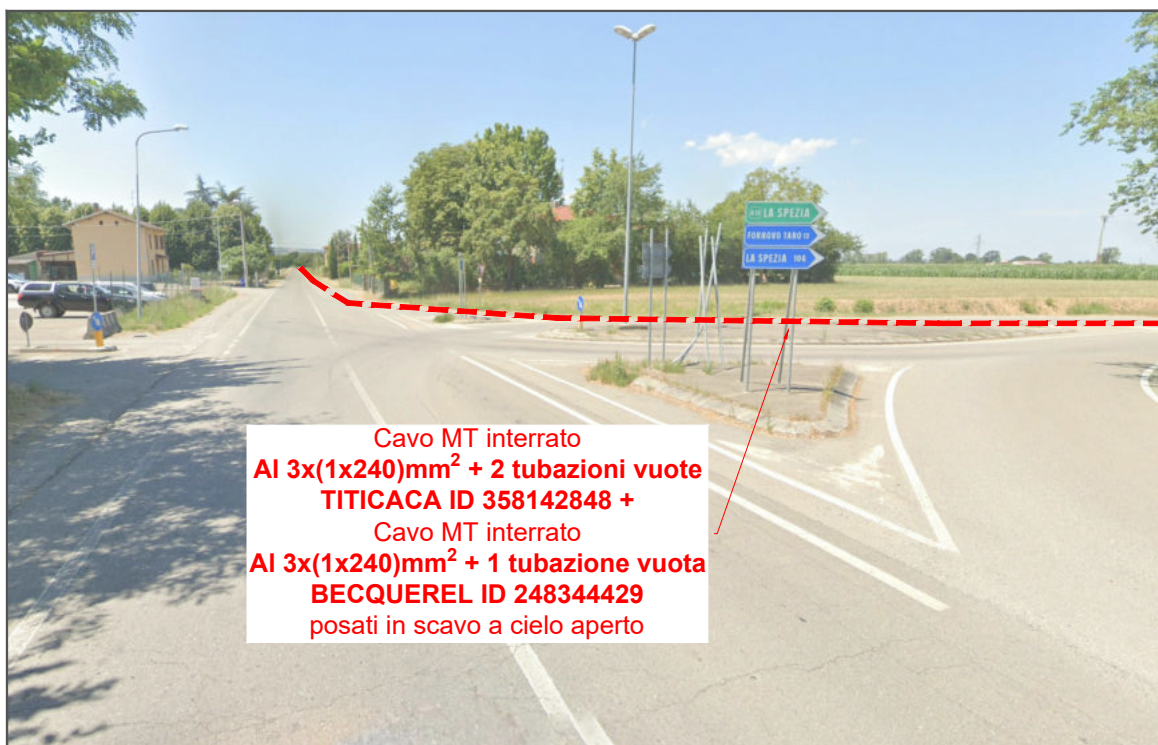
Foto 4: Nuova linea MT in partenza dalla cabina primaria CP COLLECCHIO in interferenza con lo svincolo della Strada Statale 62
