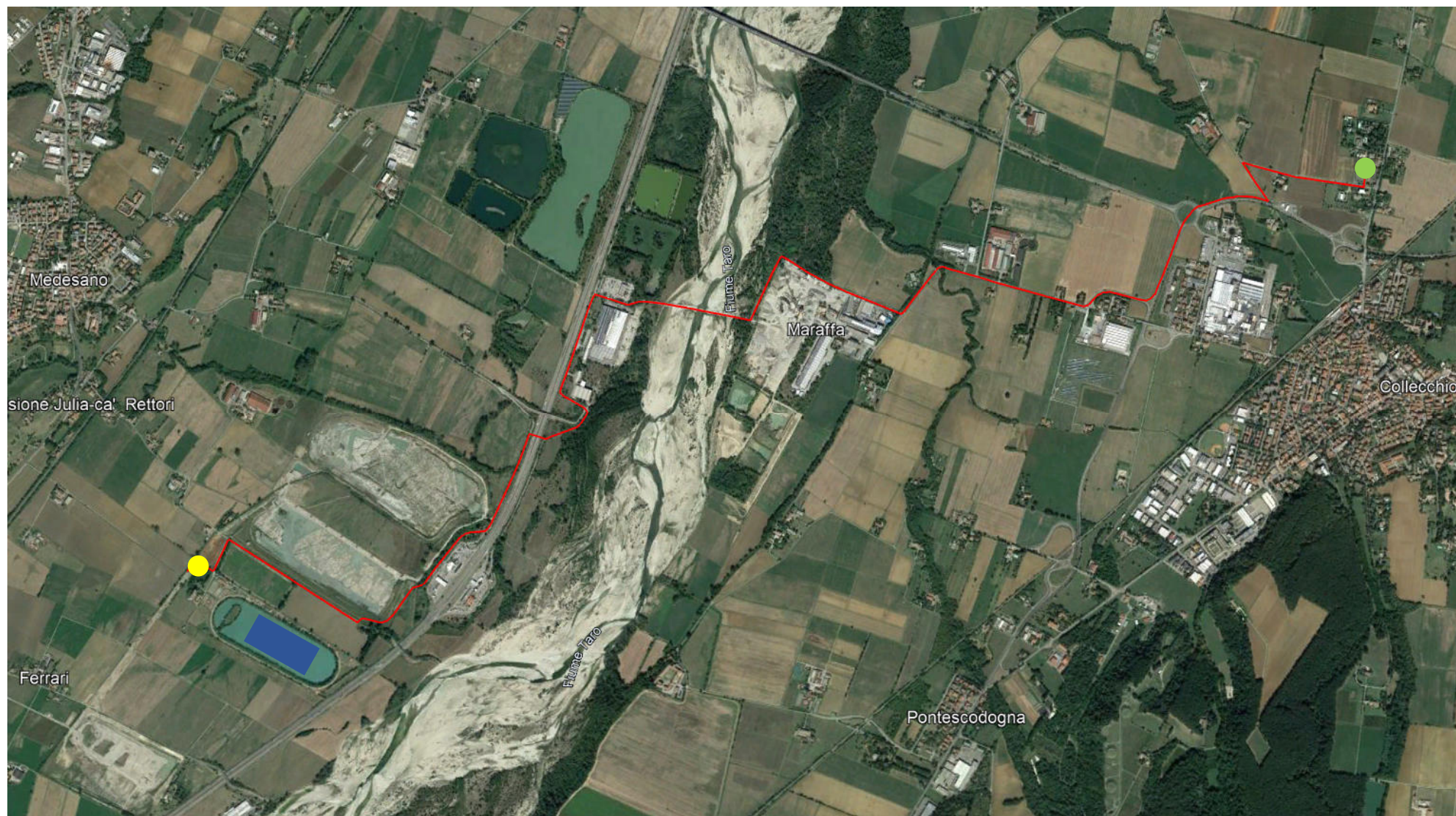
Figura 4: Inquadramento su foto aerea del tracciato della linea di connessione (in rosso) alla cabina primaria di Collecchio (cerchio verde); in blu è indicata l'area dell'impianto fotovoltaico, con cerchio giallo la cabina di consegna (fonte: Google Earth ®)
