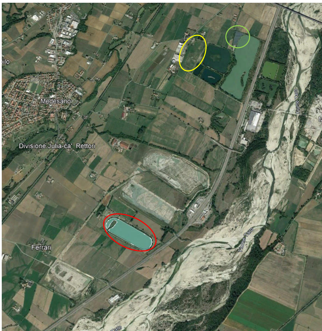
Figura 24: Localizzazione su foto area dell'impianto fotovoltaico in progetto (in rosso) e degli impianti fotovoltaici esistenti (in verde) e autorizzati (in giallo) nel territorio in esame
