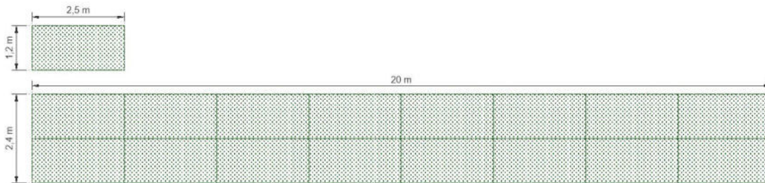
Figura 34: Schema grafico dei moduli che compongono una singola isola galleggiante
