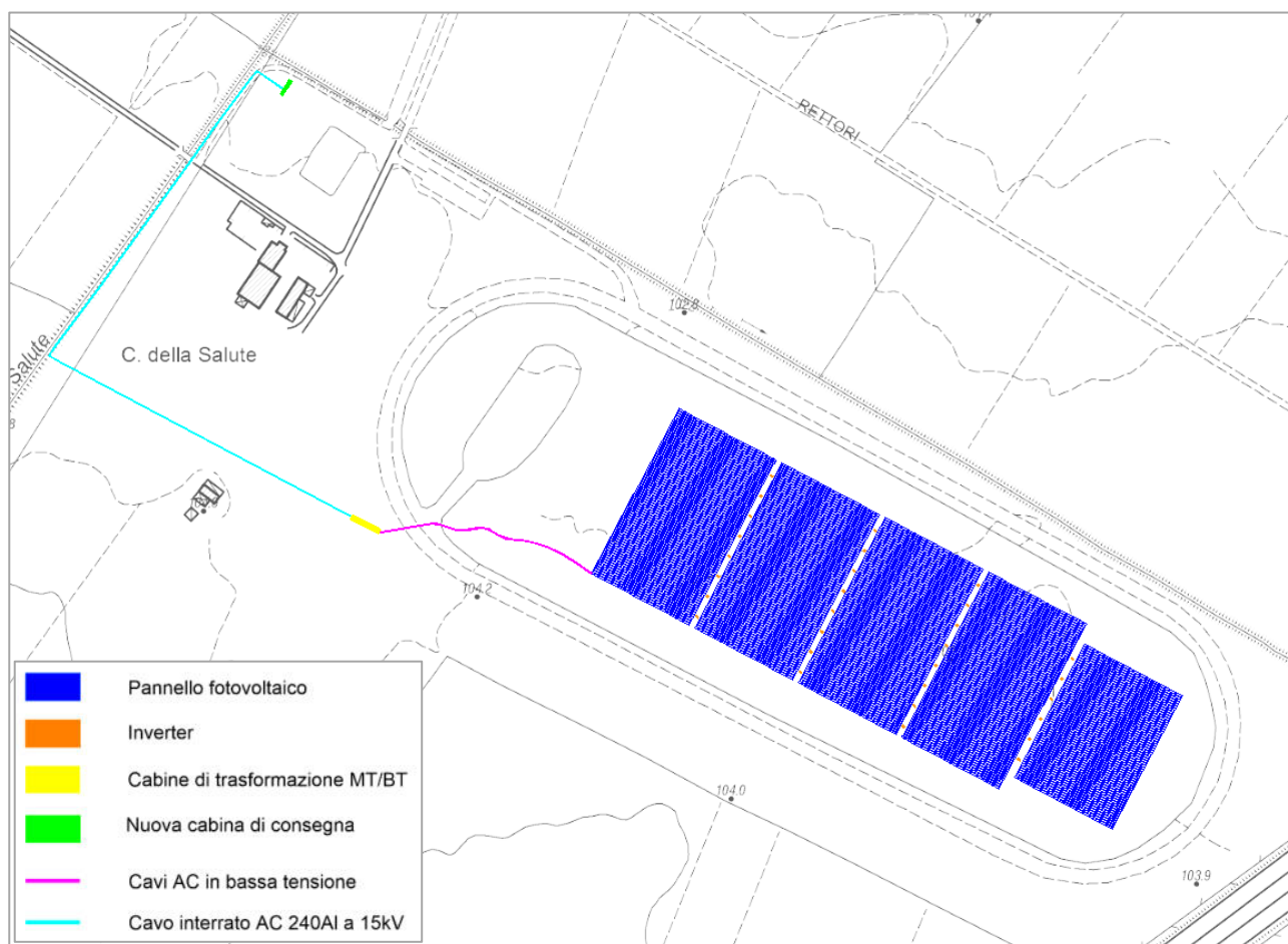
Figura 2: Inquadramento di dettaglio su CTR dell'area di progetto.
