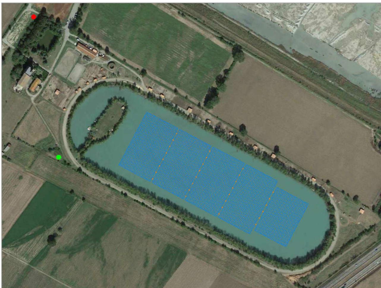
Figura 3: Inquadramento di dettaglio su foto aerea dell'area di progetto (fonte: Google Earth ®); in blu è indicato l'impianto fotovoltaico, con cerchio verde le cabine di trasformazione e con cerchio rosso la cabina di consegna
