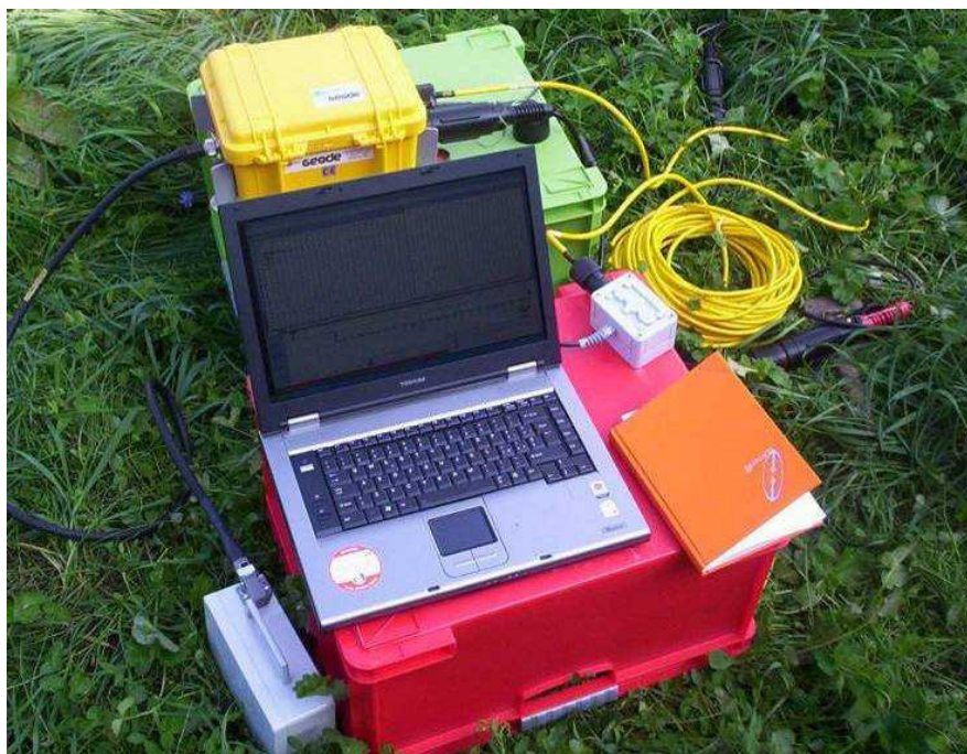
Figura 29 - Strumentazione utilizzata per la prova MASW
