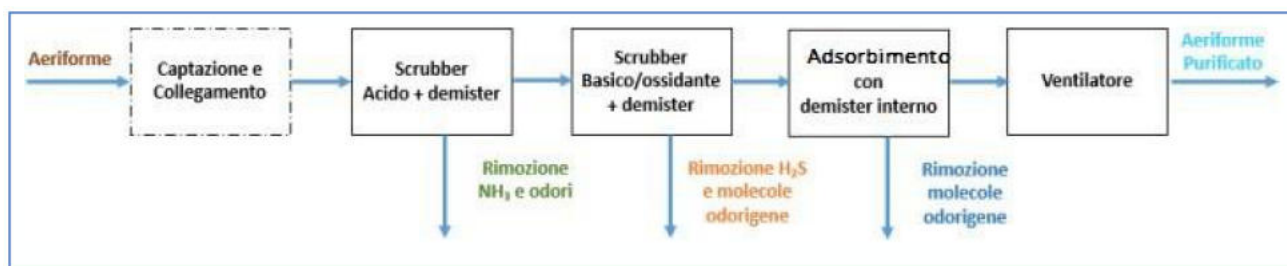
Figura 4-2: schema processo abbattimento emissioni odorogene
