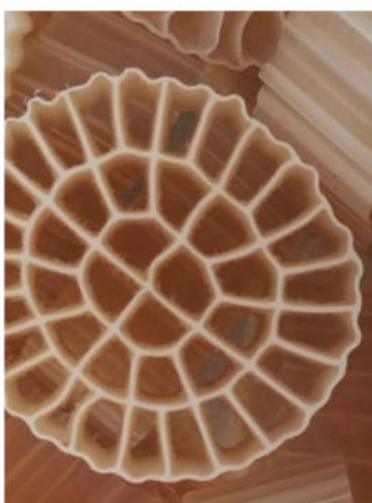
Figura 2-5: tipologia riempimento utilizzato per sistema IFAS
