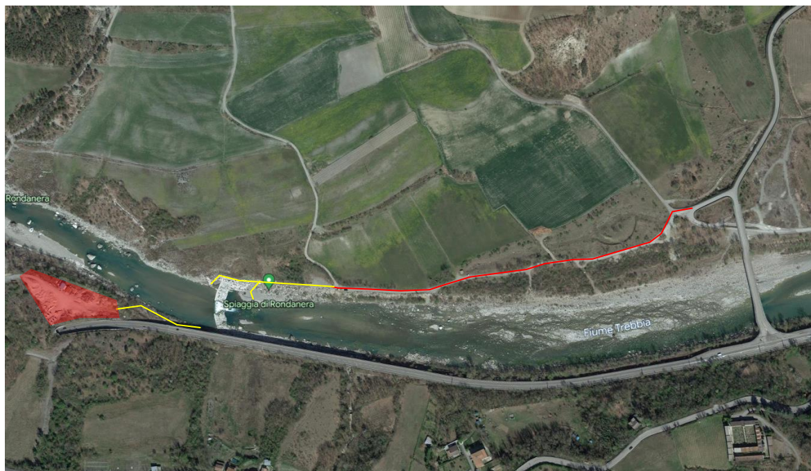
Figura 2-15 – Individuazione degli accessi all'area di cantiere. In sponda sinistra: in rosso è riportata la viabilità esistente, in giallo si individua il prolungamento della pista che dovrà essere realizzato per permettere ai mezzi d'opera di raggiungere l'area di intervento. In sponda destra: si individua in rosso l'area di proprietà della ditta Covati Pietro & C. Snc e in giallo la rampa di discesa all'alveo
