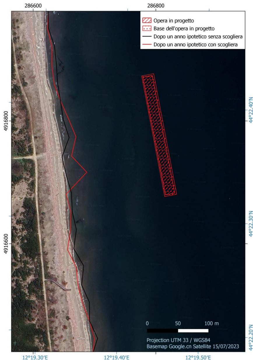
Figura 19 Simulazione dell'evoluzione della linea di riva considerando l'attacco del moto ondoso di un anno significativo, con e senza la scogliera (proiezione UTM33/WGS84).
