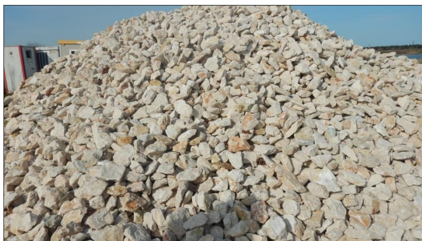
Figura 4 Esempio di materiale calcareo a spigolo vivo (spaccato) dimensione 100/200 mm.
