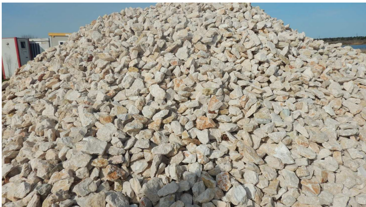
Materiale calcareo a spigolo vivo (spaccato) dimensione 100/200 mm
