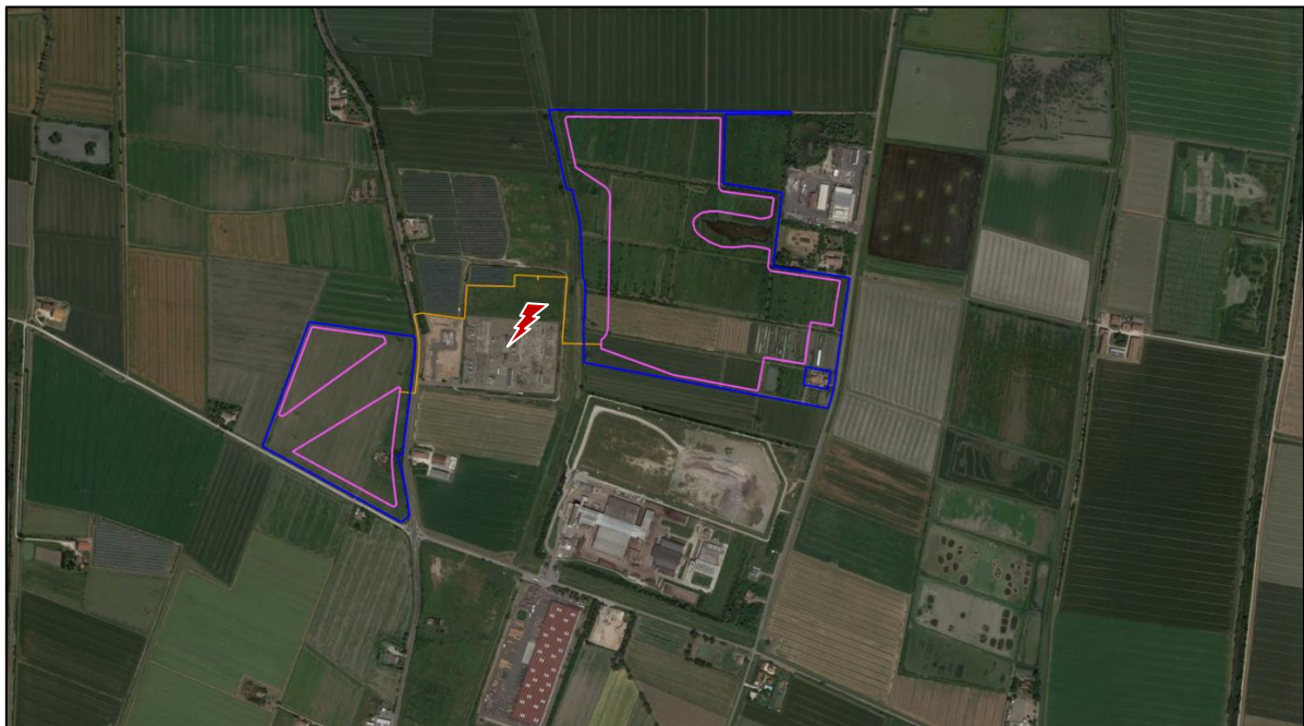
Figura 3. Localizzazione puntuale dell’area di intervento e relative opere di rete su foto satellitare: linea blu= superficie catastale; linea magenta= area di impianto; linea arancione= cavidotto di connessione; puntalino rosso = Stazione elettrica 380/132/36 kV “Carpi” – (Fonte cartografica di base: Google Earth).
