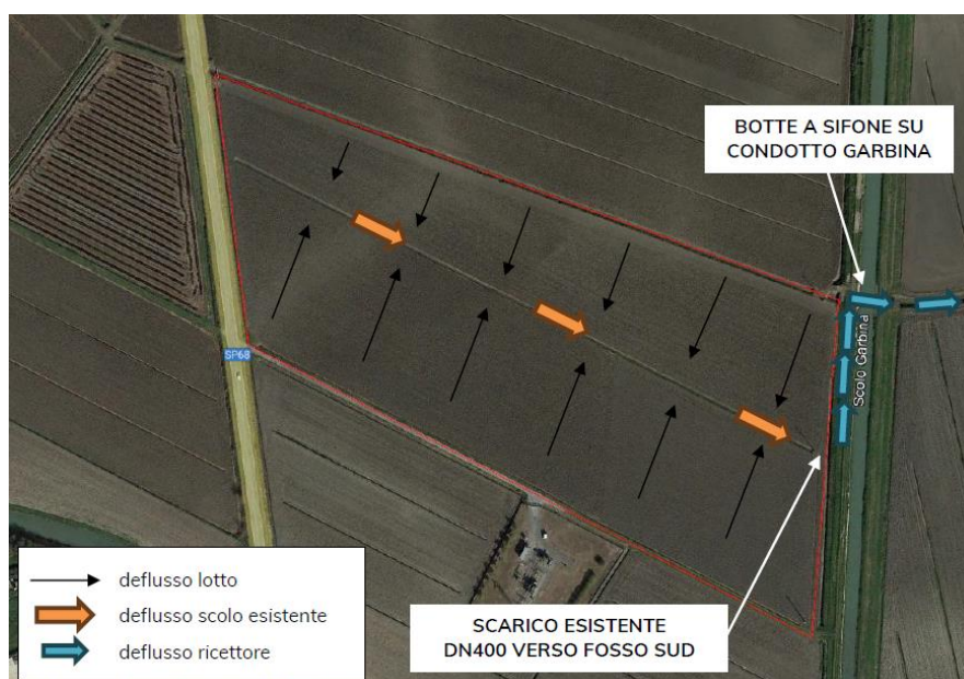
Figura 61 - Schema del deflusso delle acque interne all'area
