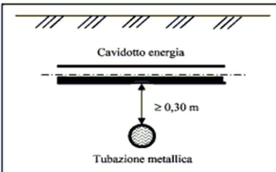
Nei percorsi **paralleli** tra cavidotti e tubazioni metalliche interrato deve essere mantenuta la maggiore distanza possibile. In ogni caso la distanza misurata in proiezione orizzontale tra le superfici affacciate delle due tubazioni deve essere di almeno 0,30 m.
