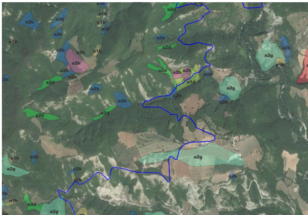
Figura 11 – Cavidotto di progetto con individuazione aree interessate da depositi di frana quiescenti e attivi
