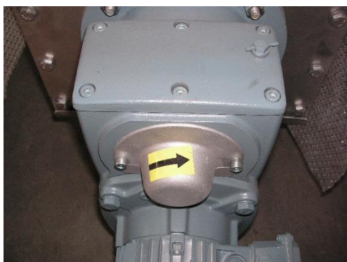
Foto 3 : Senso corretto di rotazione del motore
