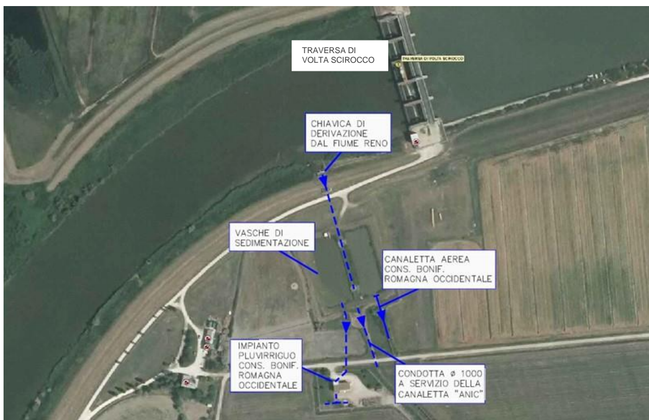
Figura 1.3 – Principali opere di derivazione del Fiume Reno
