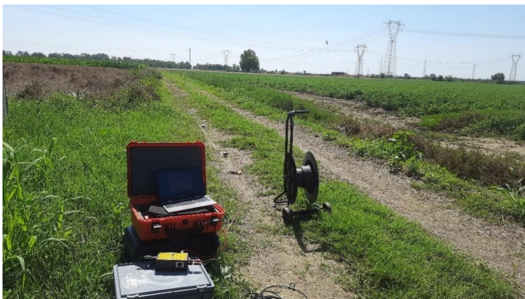
Figura 3-4 – Foto dello stendimento sismico di tipo MASW
