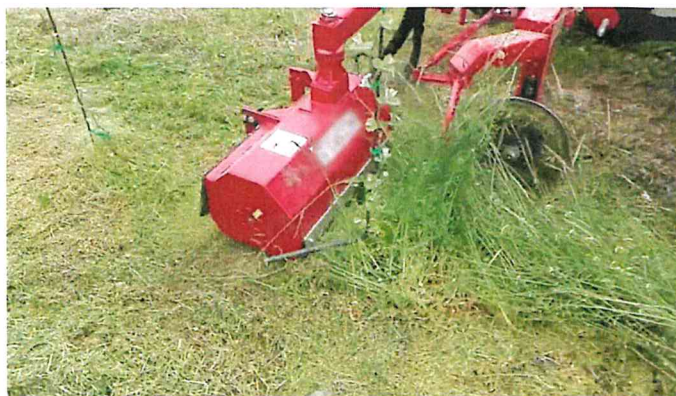
Figura 5 – Esempio di trinciatrice interceppo e lavorazione sulla fila in un frutteto al primo anno.
