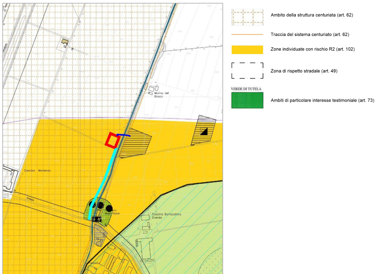
Figura 6.4.1:: Stralcio della Tavola P1 "Zonizzazione", in rosso è indicata l'area della sottostazione elettrica MT/AT, in blu il tracciato della linea elettrica AT e in azzurro il percorso di accesso alla sottostazione di progetto.
